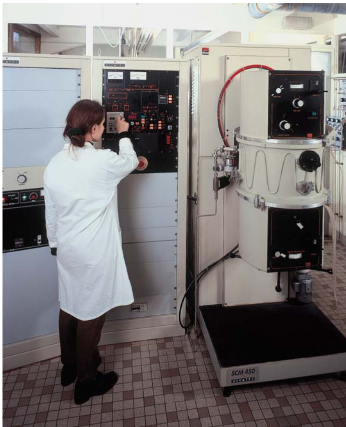
Machine de dépôt sous vide
