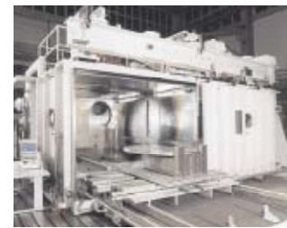
Vakuumkammer einer großen Elektronenstrahlschweißanlage
