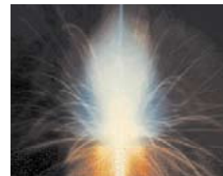
Der Elektronenstrahl dringt tief in das Material des Werkstückes ein
