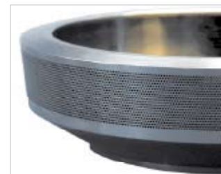
Spinddüse mit Löchern, gebohrt mit einem Elektronenstrahl
